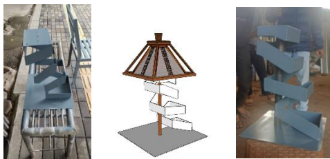
Gambar 10. Struktur spiral dan pengkaku vertikal Sumber: Foto pengembangan desain
